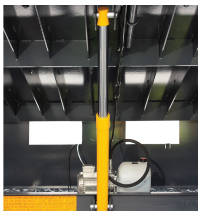
Cilindro de elevación con válvula anticaída.
